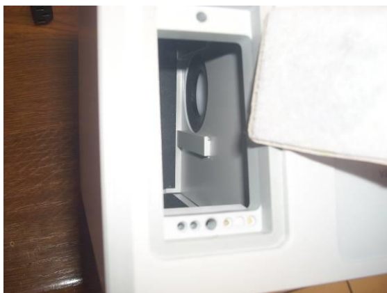
Fig. 8: Öppningen för luftintagsfiltret
