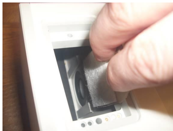
Fig. 9: Insättning av luftintagsfiltret
