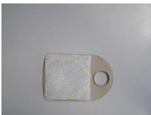
Fig. 10.: Framsidan av luftintagsfilteret
