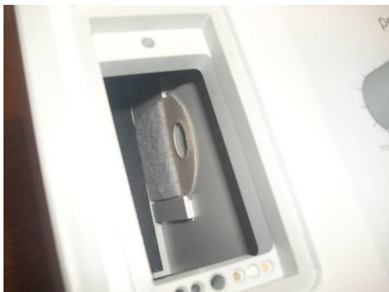
Fig. 6: Sugkammaren tillsammans med luftintagsfiltret
