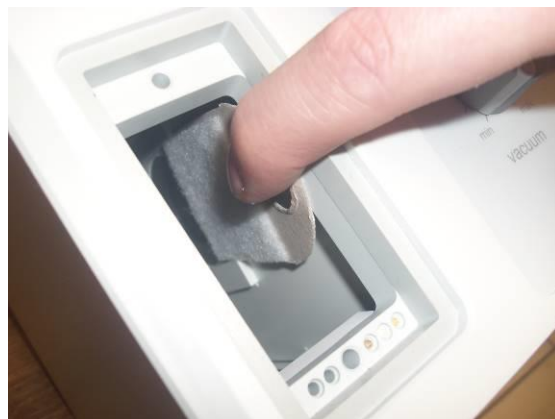
Fig. 7: Borttagning av luftintagsfilteret
