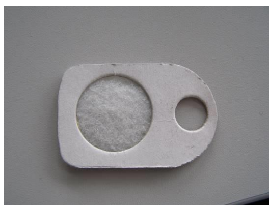
Fig. 11: Baksidan av luftintagsfilteret
